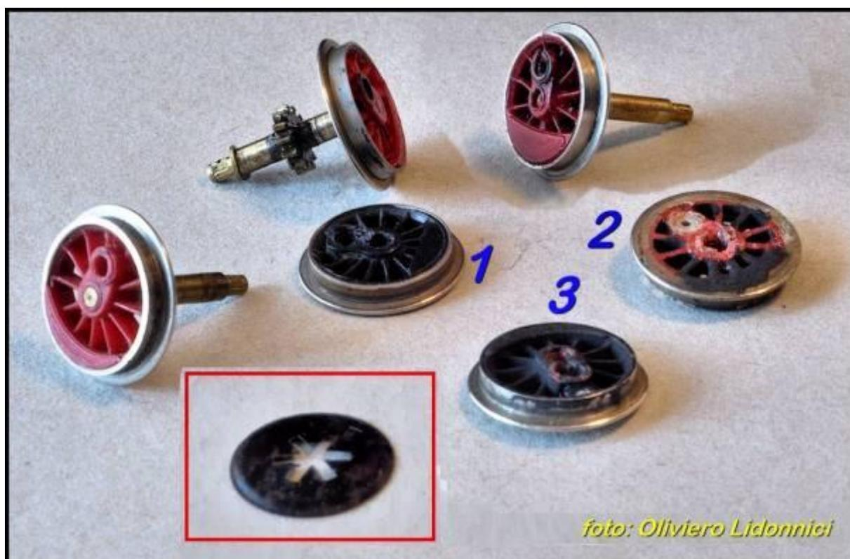
Particolare cura occorre nel montaggio delle ruote sugli assi: le ruote di destra devono essere sfalsate di un quarto di giro (90°) rispetto a quelle di sinistra in modo che quando la biella su un lato si trova nel punto più basso, quella sul lato opposto si posizioni a mezza ruota, allineata orizzontalmente ai mozzi.
